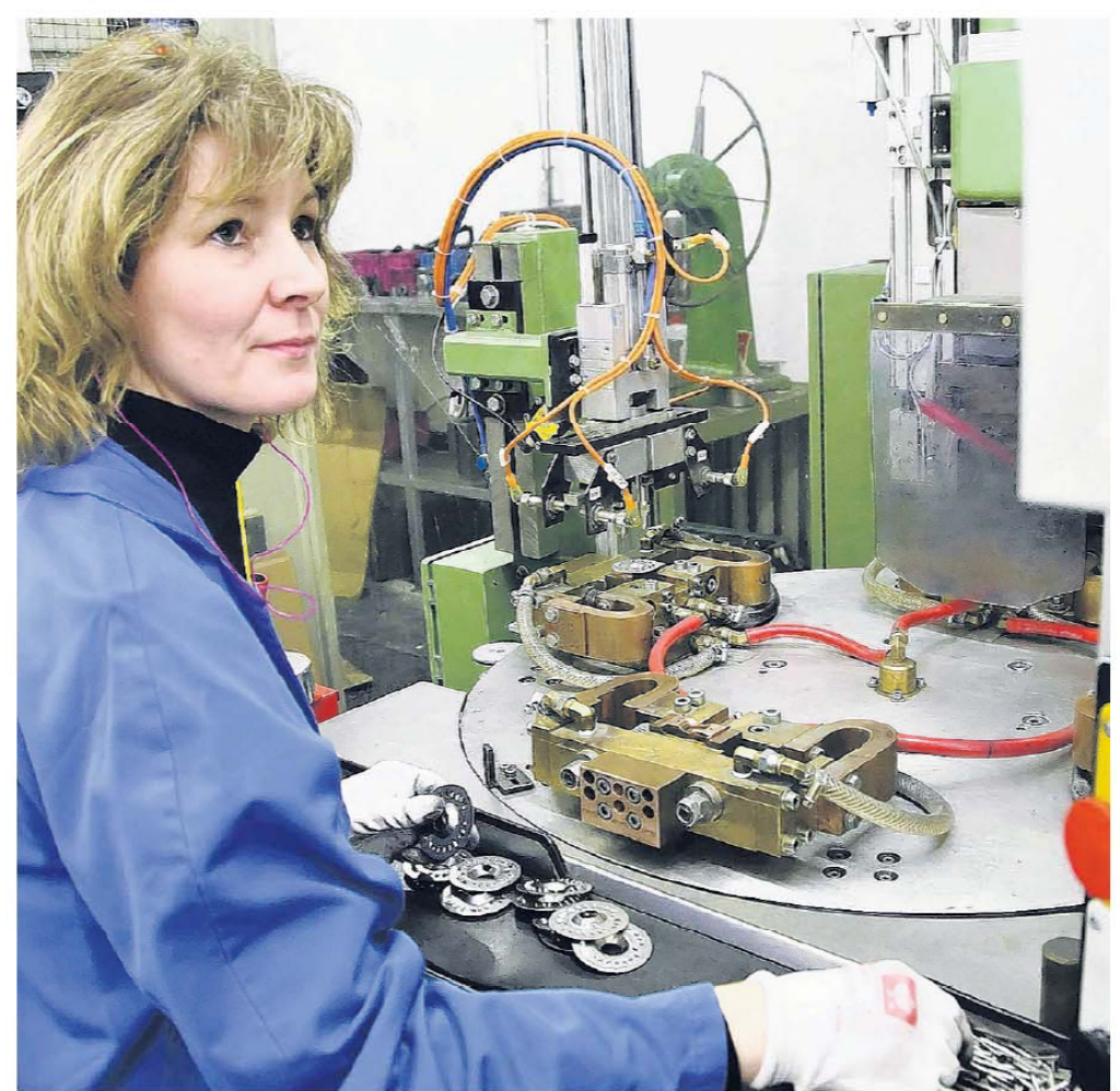
Sylke Winter arbeitet am Schweißautomaten für Hitzeschilde, die in Standheizungen eingebaut werden. FOTO: ZANDER
