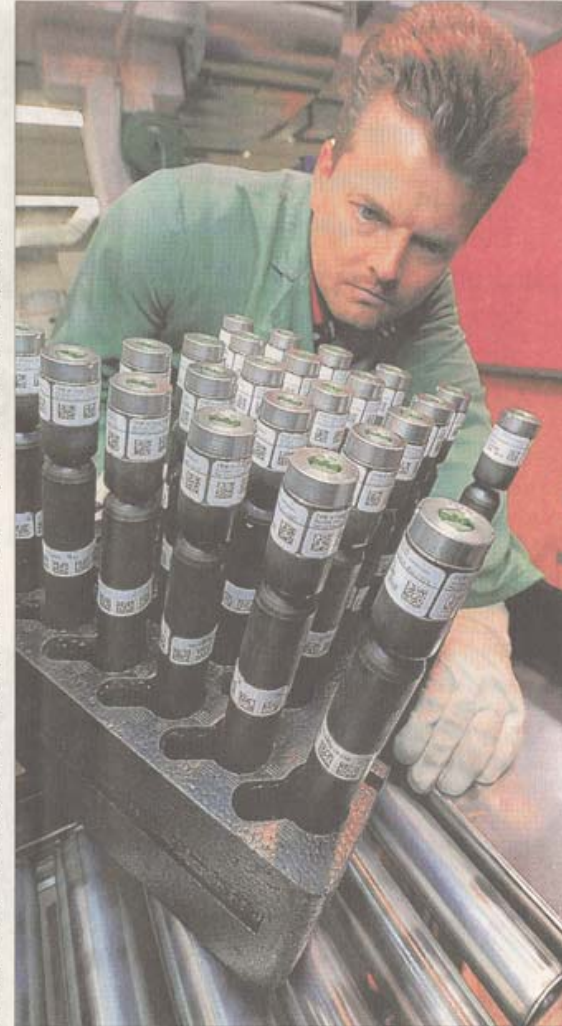
Bernd Galitzki (39) in der TRW Airbag Systems GmbH in Laage bei der optischen Endkontrolle von Airbag-Generatoren. Fotos (5): Frank Söllner
